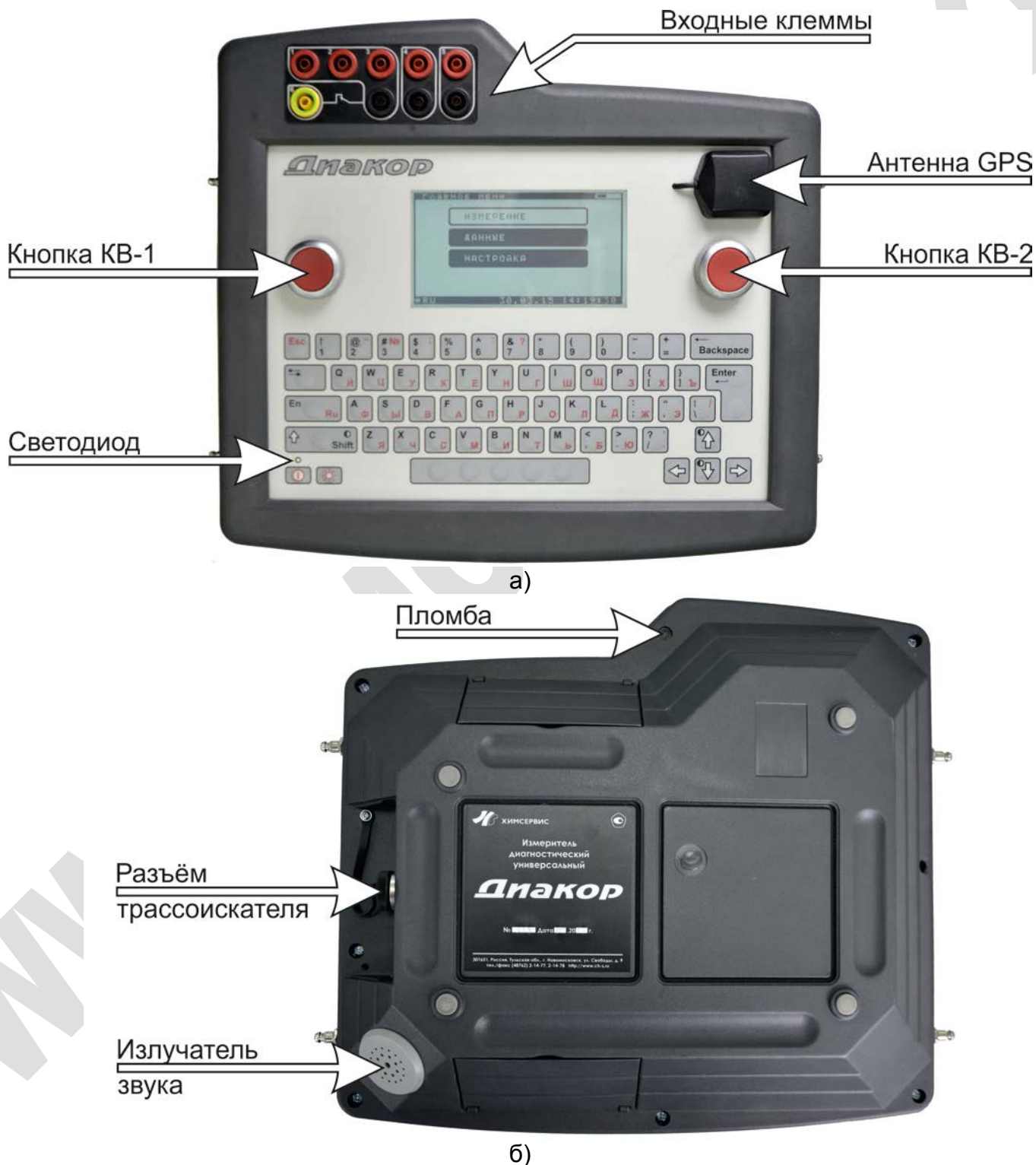
Рисунок 2.1.1 – Внешний вид прибора а) лицевая сторона; б) тыльная сторона.
